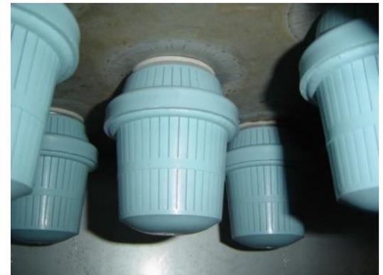
**Colunas Resinas:** Tanques cilíndricos de aço carbono ou inoxidável com calotas torrisféricas (superior e inferior), contendo Fundo Falso com Crepinas
