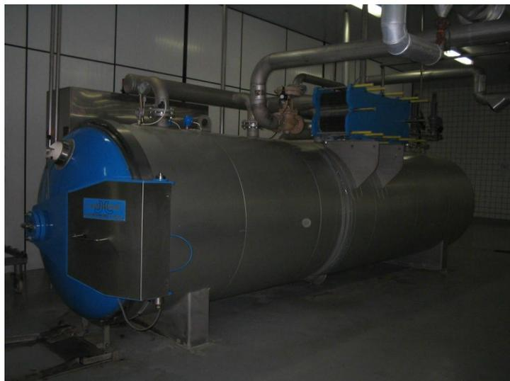
Figura 14 - Detalhe da Autoclave utilizada para Esterilização e Cozimento (KREUTZ, 2006)
