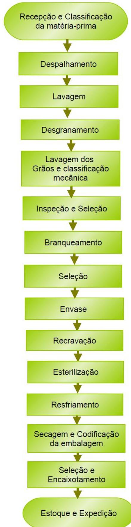
Figura 16 -Fluxograma do Processamento do Milho Enlatado (KREUTZ, p.47, 2006)
