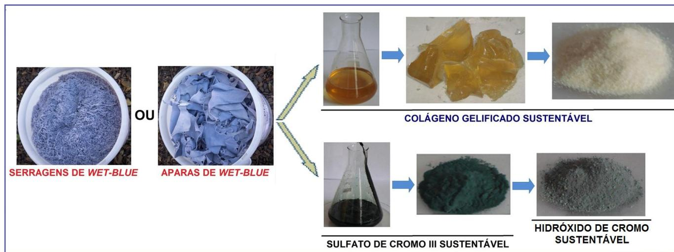
**Figura 1.** Extração de colágeno gelificado sustentável, sulfato de cromo III sustentável e/ou hidróxido de cromo sustentável de serragens e aparas de *wet-blue* (FÉLIX DE SOUSA, 2005).
