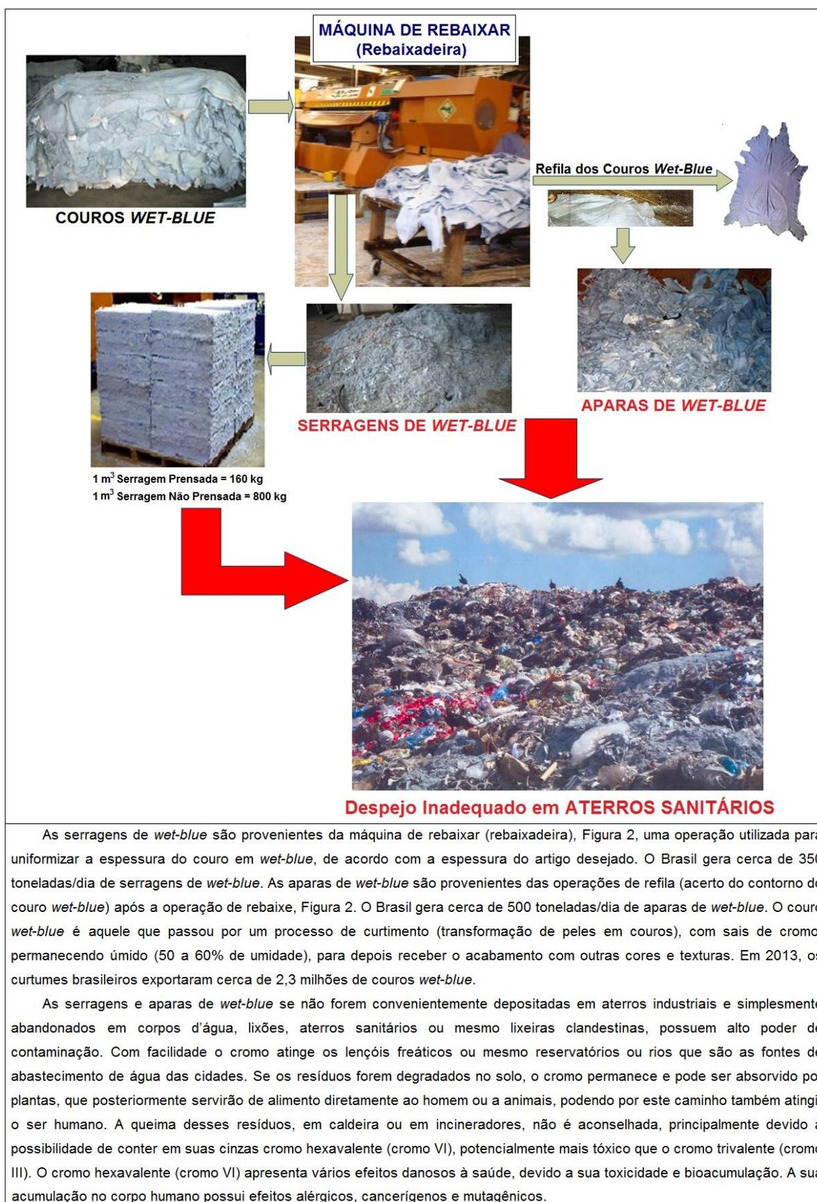
**Figura 2.** Geração de serragens e aparas de *wet-blue* e despejo inadequado em aterros sanitários (FÉLIX DE SOUSA, 2005).
