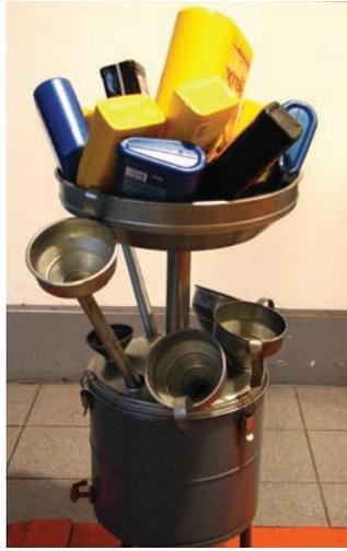
**Equipamento para escoamento de óleo lubrificante**
