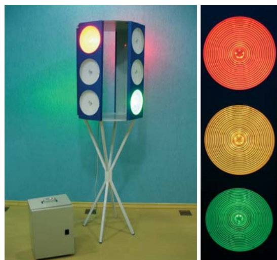
O semáforo de LED proporciona mais segurança ao condutor do veículo, que terá mais facilidade para identificar se ele está aberto ou fechado. A disposição dos LEDs distribui melhor a luz, aumentando a luminosidade. (Imagens cedidas pelo Projeto de Inovação Tecnológica do Centro de Pesquisa em Óptica e Fotônica - Cepof, coordenado pelo Prof. Dr. Vanderlei Salvador Bagnato, USP/São Carlos).
