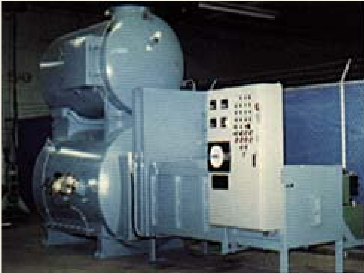
Incinerador de Resíduos de Serviços de Saúde
