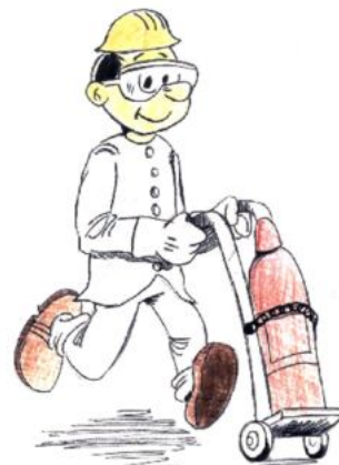
Transportar em carrinhos próprios e acorrentados
