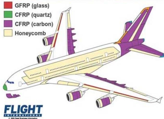
Compósitos de fibra de vidro ou de carbono combinados com diferentes matrizes termofixas ou termoplásticas.
