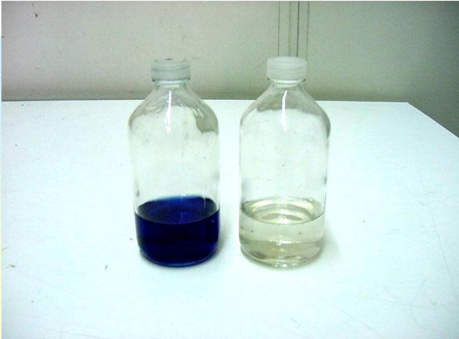
**Solução de corante R-19 antes e após 1 hora de tratamento pelo processo Foto-Fenton**
