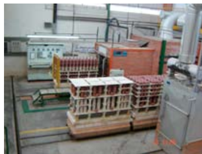
Figura 32- Carregamento de forno túnel
