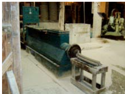
Figura 16 e 17- Processo de extrusão de massa cerâmica
