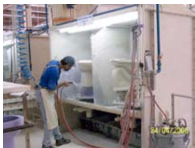
Figura 26 Aplicação de esmalte por pulverização
