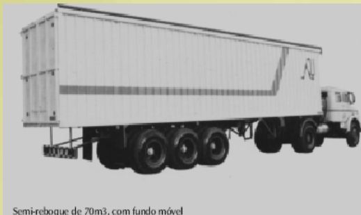
Semi-reboque de 70m 3 , com fundo móvel
